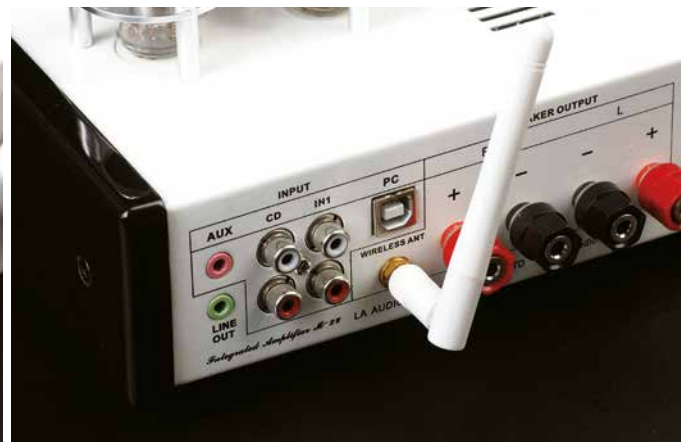
▲左：面板上方被有一個USB輸入埠，可以讓用家將電腦裡的音樂檔案存至USB隨身碟中，來讓M-2B播放聆聽使用。 右：M-2B可利用USB、藍牙、類比RCA、3.5mmRCA輸入音源，使用上相當方便。
